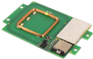
TWN4 MultiTech 2 BLE PCB top view
